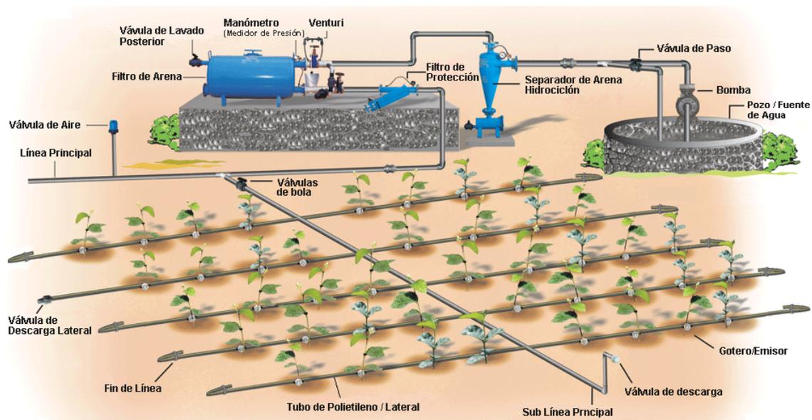
**Figura 1.** Modelo de Diseño del Sistema de Riego por Goteo (Fuente: [www.jains.com](http://www.jains.com))
